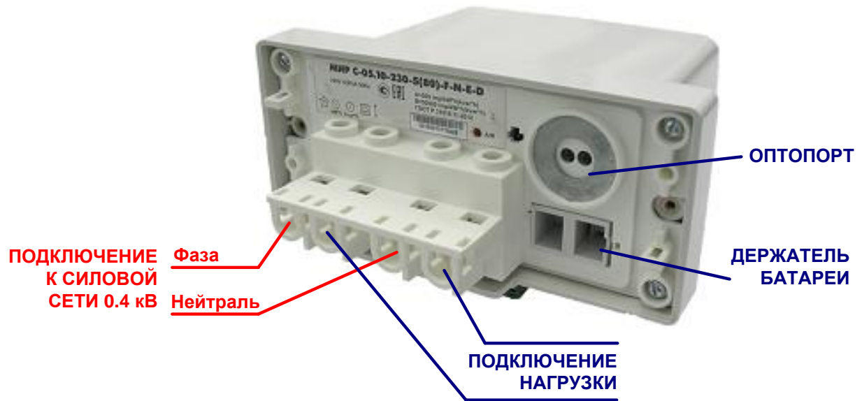
Рисунок Б.5 – Счетчик для наружной установки со снятой крышкой зажимов
