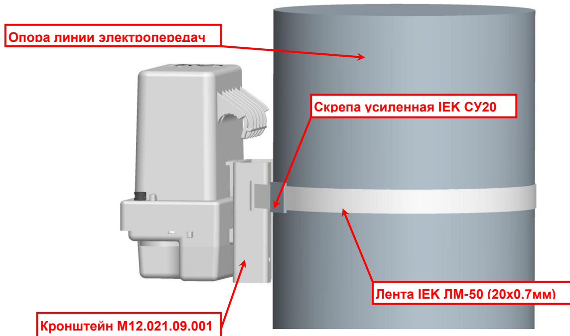
Рисунок 9.2 – Установка счетчика на опору линии электропередач
