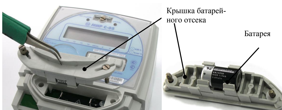
Рисунок 14.1 – Замена батареи в счетчике, применяемом внутри помещения
