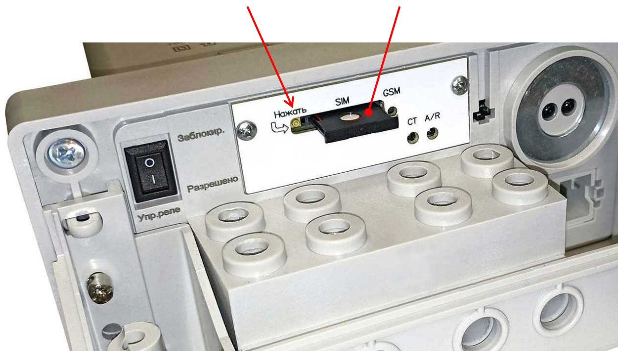
Рисунок 14.6 – Замена SIM-карты в счетчике для наружной установки
