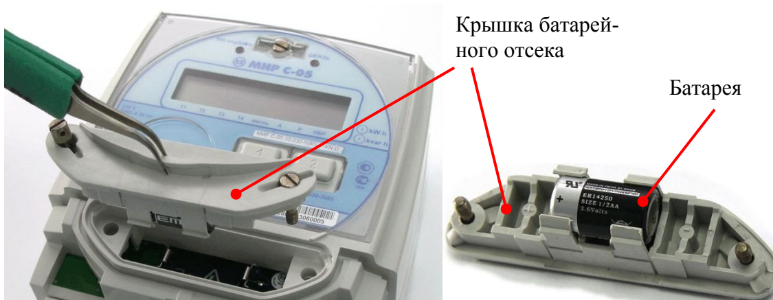
Рисунок 14.1 – Замена батареи в счетчике для внутренней установки
