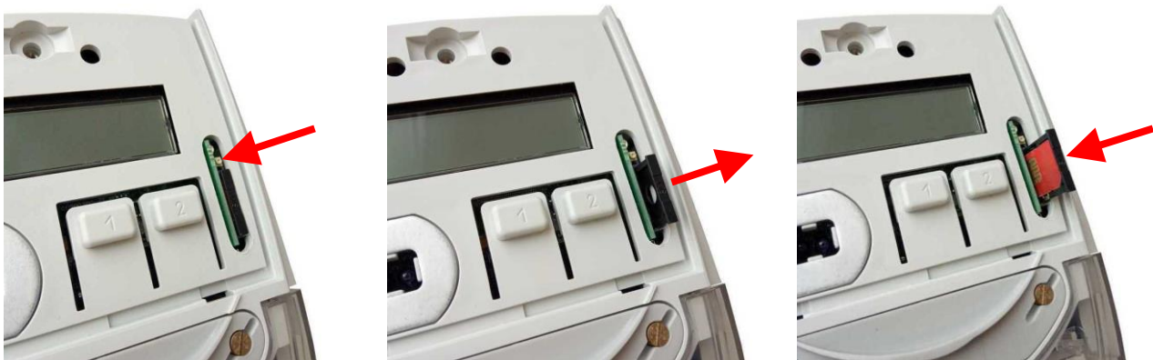
Рисунок 14.5 – Установка SIM-карты в счетчике для внутренней установки
